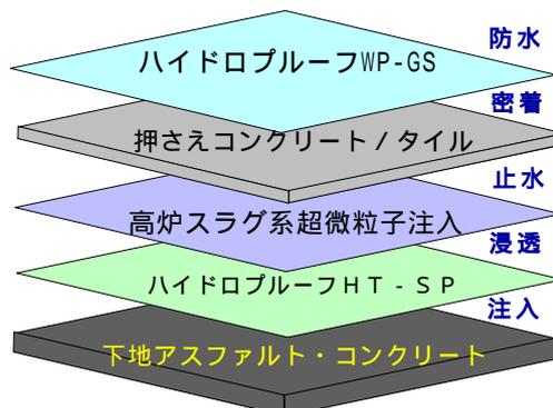
ハイドロプルーフHT-SPを先行注入することで劣化した躯体の強化と、注入材の接着力を高めます。高炉スラグ系超微粒子注入材のが躯体背面を移動し、漏水箇所から流出し亀裂内部で固化、一体化します。施工範囲が大きい場所でも、小さい場所でも同一施工で完了します。
