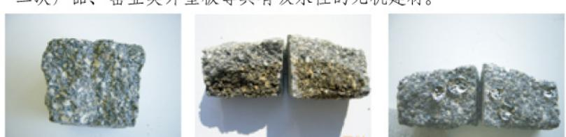
将Heritage涂抹在凝灰岩上面并浸透后、、如上图所示发生了割裂、内部吸入了水分。Heritage接触到了空气中的碳酸气体和水分、随着时间的推移、断面开始防水、7~20日后凝灰岩从整体上具备了防水功能。这是因为反应性催化剂进行加水分解、疏水基开始增加。用建筑现场的耐火板等对建材进行疏水预涂饰、即使在对这样的建材进行了切割加工后、断面仍可以保持防水功能直至竣工。施工后、切割下来的部分在一定时间后(7~20日)其龟裂面仍然可以防水。在其应用方面、浸透的水分或水印、通过加水分解或置换作用经过一定的时间即可消除。
