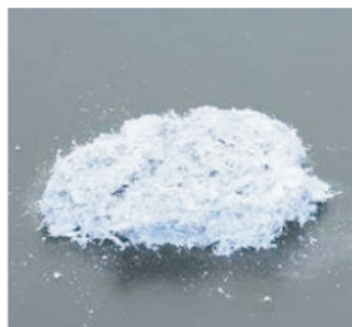
吹き付けアスベストの原料
